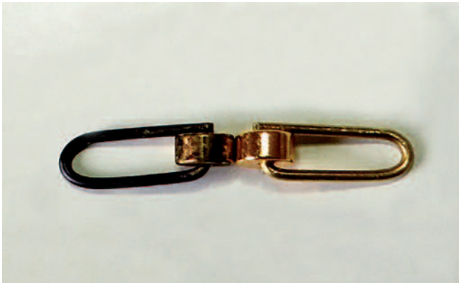
Die Abbildung zeigt die zwei Kupplungsbügel mit Magneten, der linke ist bereits brüniert.
