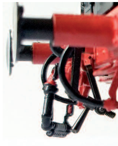
Die Abbildung der Pufferbohle der Dampflokomotive 03 1010 zeigt den eingehängten Kupplungsbügel im Kupplungsruehaken.
