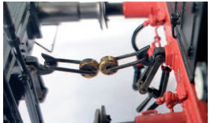
Auf dieser Abbildung verrichten die Magnete ihre Arbeit und ziehen die beiden Fahrzeuge zusammen.
