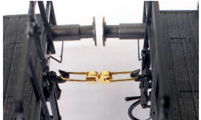
Die Abbildung zeigt den unmittelbaren Kuppelvorgang, die Fahrzeuge sind hier magnetisch im langgemachten Zustand verbunden.
