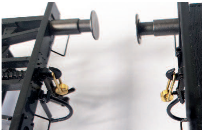
Die Kuppelköpfe sind in die Zughaken der Fahrzeuge eingehängt. Der Kuppelvorgang kann beginnen.
