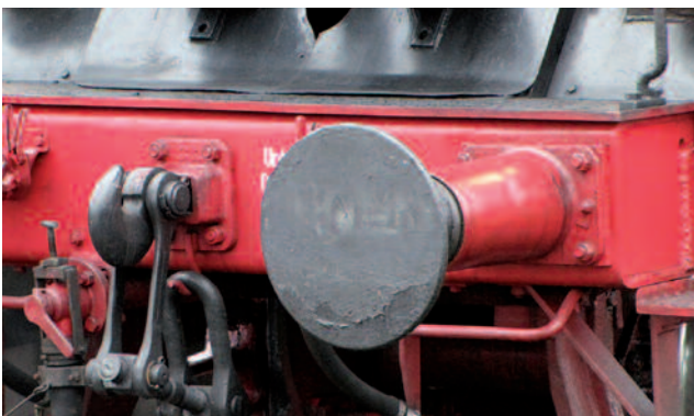
Die Abbildung der Pufferbohle der Dampflokomotive 03 1010 zeigt den eingehängten Kupplungsbügel im Kupplungsruehaken.
